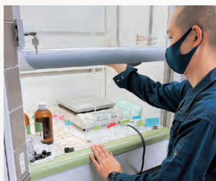
測定に使用するJIS T 8202に準拠した一般用風速計
