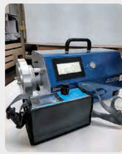
ハイボリュームエアサンプラー 空気中の粉じんおよびオイルミスト等の測定に使用
