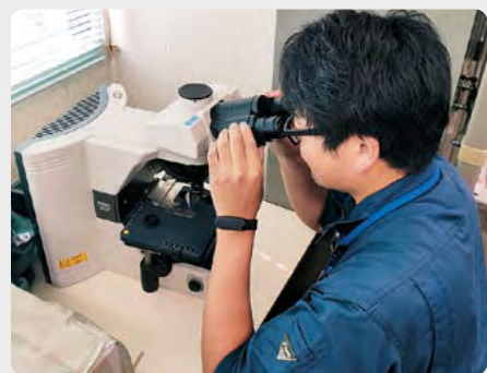
アスベストおよびグラスウールの計数作業 顕微鏡でサンプル中に含まれるアスベストやグラスウールの数を地道にカウント
