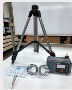
ミニポンプ 有機溶剤、特定化学物質等の測定に使用
