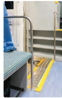
【手すり・ラバー】 移動部分には手すりを、壁面や角部分にはラバーを設置し、高齢者にも優しい安全対策を施しています。
